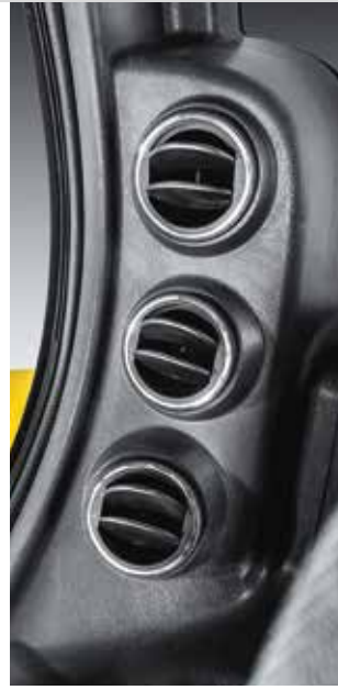
• Isıtma ve soğutma için güçlü havalandırma sistemi • E37C modelinde manuel, E57C ve E60C modellerinde otomatik standart klima
